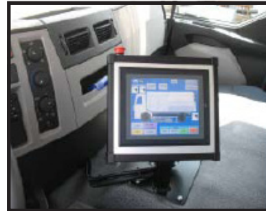
Touchscreen im Fahrerhaus zur Steuerung der Sauganlage
